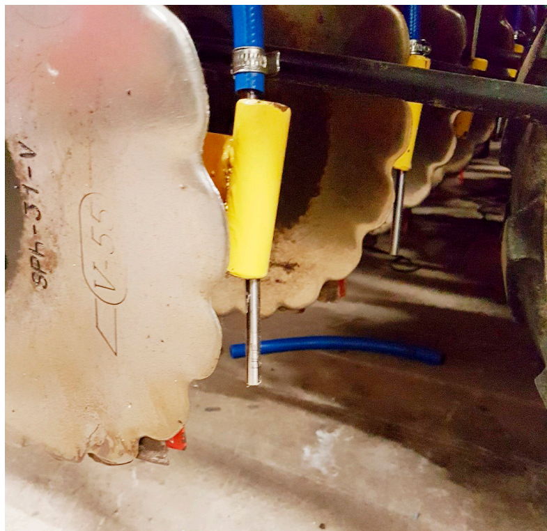
■ Eksempel på placering af flydende gødning direkte i sårillen hos norsk landmand. Foto: Flex Fertilizer System
